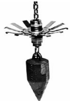
Die Feuerwehr löscht solche Brände z.B. dadurch, dass sie das brennbare Material mit Hilfe eines sogenannten Brandkehrgeräts entfernt. Das ist eine schwere Metallkugel mit seitlichen Metallborsten, die sie an einer Kette dann Etage für Etage durch den Schornstein zieht.
